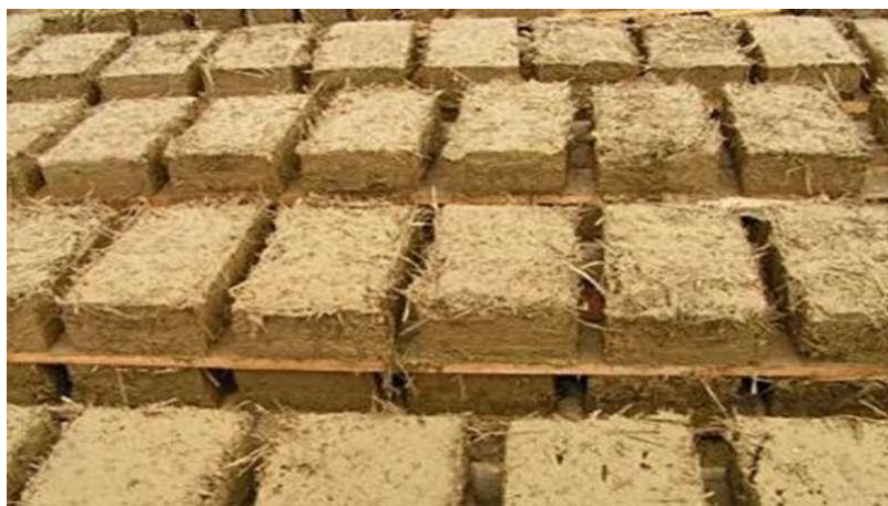
Рис. 1. Саман - кирпич из глины и соломы с добавлением воды
