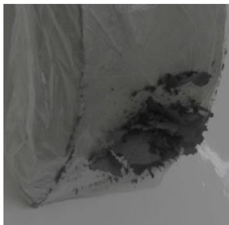
Рис. 1. Вид сухого осадка из раствора СОЖ при магнитной сепарации
