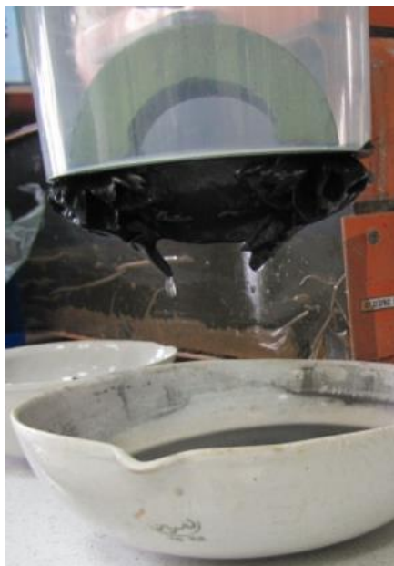
Рис.2. Магнитная сепарация СОЖ
